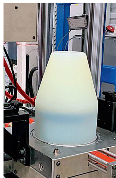
Стресс-конус для концевой кабельной муфты класса напряжения 500 кВ, произведенный впервые в России на заводе «Изолятор-АКС»
