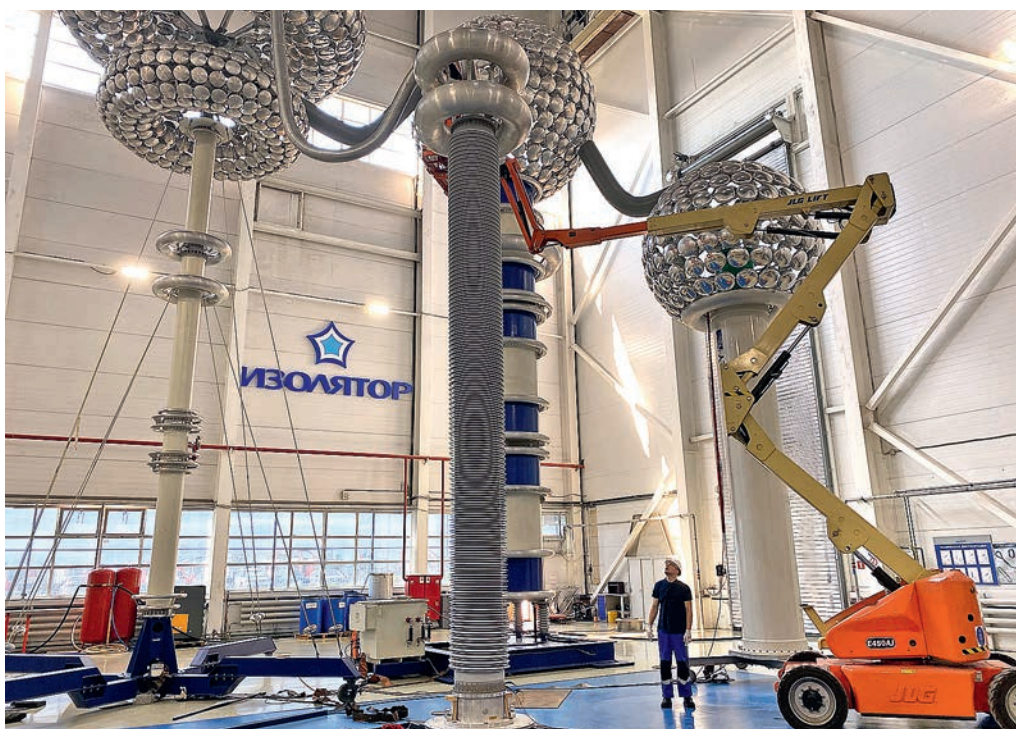
Ввод «Изолятор» 800 кВ / 2000 А (в центре), изготовленный для индийской государственной электросетевой компании Power Grid Corporation of India Limited
