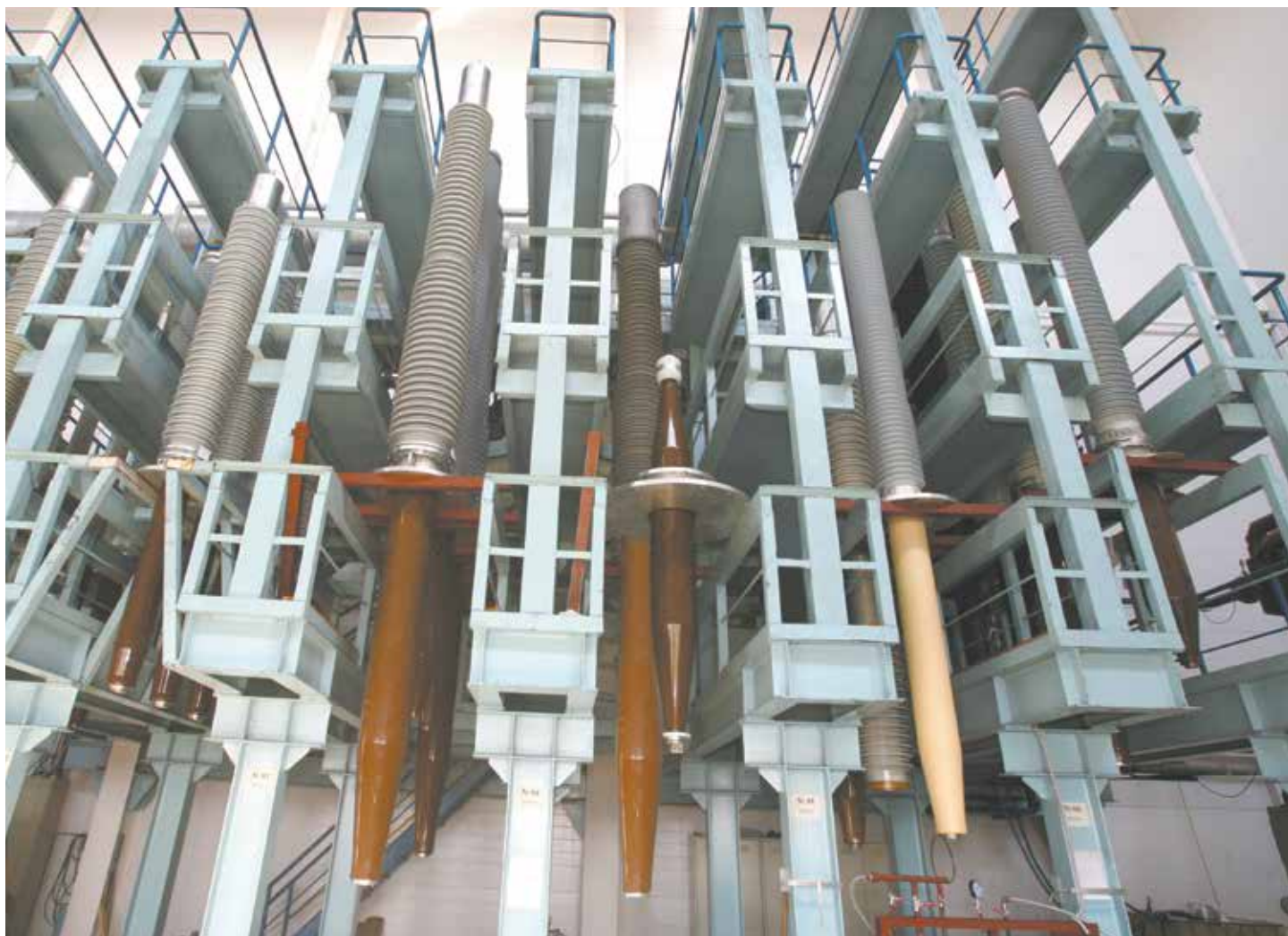
Высоковольтные вводы на технологических стойках в сборочном цехе завода «Изолятор»
