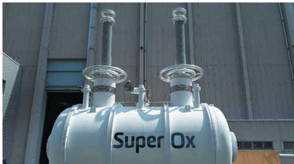
Первая фаза сверхпроводникового ограничителя тока класса напряжения 220 кВ, оборудованная вводами «Изолятор», в испытательном центре KERI
