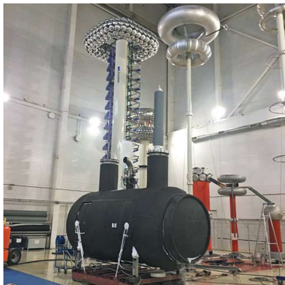
Токоограничивающее устройство разработки компании «СуперОкс» в испытательном центре завода «Изолятор»
