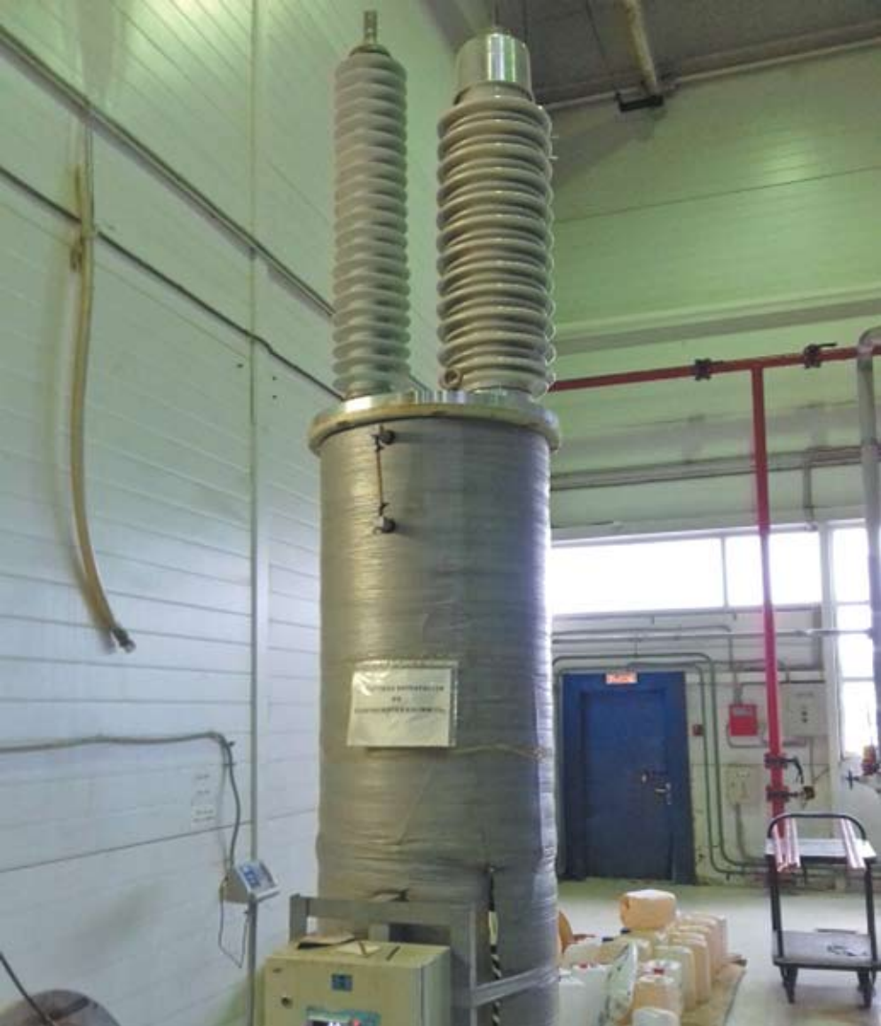
Рисунок 1. Испытание на увлажнение в соленом тумане вводов 110 кВ
