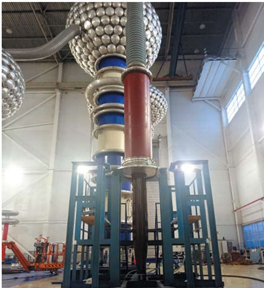
Испытания на заводе «Изолятор» ввода «масло–элегаз» на класс напряжения 500 кВ
