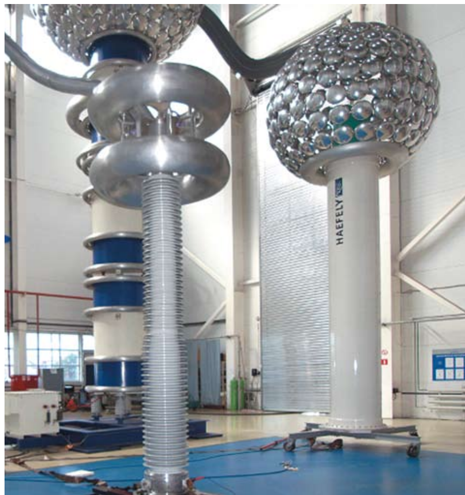
Ввод 500 кВ с RIN-изоляцией в испытательном центре завода «Изолятор»
